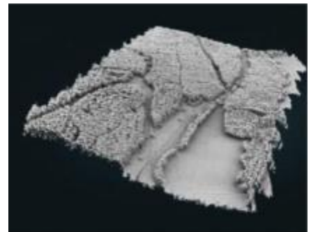
Figura 7: Mappatura effettuata dal sensore LIDAR
